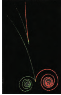
■ الشكل 20-3 عندما ينتج الجسيم فإن ضديد هذا الجسيم ينتج أيضاً. هنا تضمحل أشعة جاما إلى زوج من الإلكترون والبيوترون.
